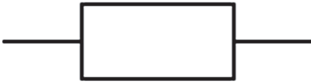
Fig. 5. Símbolo de la resistencia eléctrica en un circuito.
