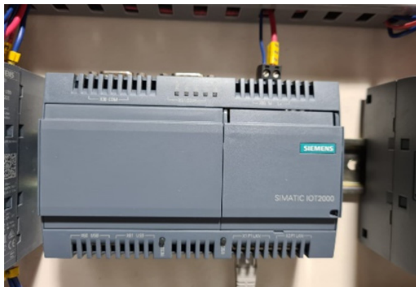
Fig 5. SIMATIC IOT 2040. Fuente: Autores.
