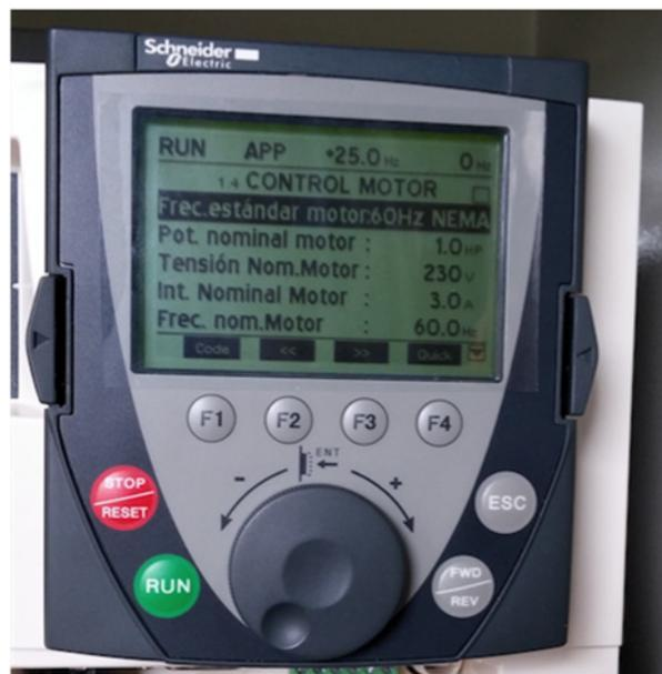
Figura 4. Configuración de parámetros del motor a controlar (Potencia, voltaje, corriente y frecuencia).
