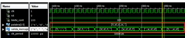
Figura 18. Desplazamiento en la salida de cada uno de los caracteres de la palabra «tdda».
