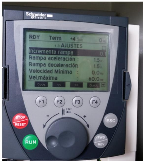
Figura 6. Configuración de la rampa que controlará el motor desde el variador [Incremento, tiempo de la rampa de aceleración y desaceleración, velocidad mínima y máxima].
